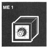
mit Frontrahmen 96×96 mm für Schalttafeleinbau
