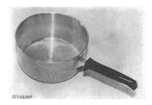
Der Boden hat bei der Formbeständigkeitsprüfung nur eine geringe Deformation erlitten. Solche Kasserollen sind daher für Verwendung auf elektrischen Herden geeignet.
