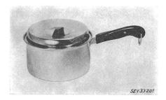
Der Boden hat bei der Formbeständigkeitsprüfung nur eine geringe Deformation erlitten. Solche Kasserollen sind daher für Verwendung auf elektrischen Herden geeignet.
