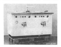
häuse aus emailliertem Stahlblech. Heizstäbe unten am Behälter in separatem, zur Hälfte mit Wasser gefülltem, luftleerem Raum eingebaut. Verstellbarer Pressostat, Sicherheitsventil, Schalter, Schaltschütze, Signallampen und Sicherungen. Mischbatterie mit schwenkbaren Hahnen. Anschlussklemmen 3 P + N + E vorhan-
