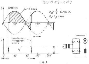
Spannungsregelung durch Anschnittsteuerung
