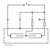
spannung wird zwischen Mittelpunkt und Nadel angelegt. Diese Meßschaltung eignet sich besonders zum Messen kleiner Spannungen. Da die Empfindlichkeit der Anzeige von der Höhe der Hilfsspannung abhängt, kann eine immer gültige Eichung noch nicht im Herstellwerk erfolgen, vielmehr wird bei der Nadelschaltung die zweite, ungeeichte, 100teilige Proportionalskale benützt. Die Ausschlagrichtung ist abhängig von der Polung der Hilfs- und Meßspannung.
