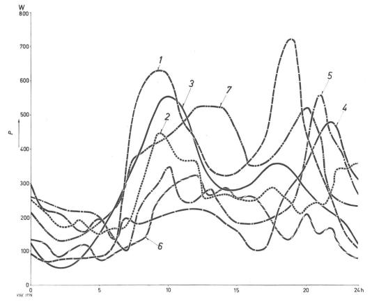
1.1 Belastungskurven von Heisswasserspeichern mit einem Fassungsvermögen über 50 l und mit Tarif ohne Sperrung (Tabelle II und zugehörige Fig. 1) (Gruppe 1 A a)
