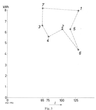
Heisswasserspeicher von über 50 l mit Tarif ohne Sperrung Korrelation zwischen dem mittleren täglichen Verbrauch [kWh] und dem mittleren Fassungsvermögen [1] der Apparate für Verbrauchergruppen in verschiedenen Ländern
