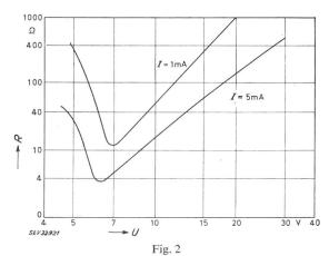
Abhängigkeit des dynamischen Widerstandes von der Zenerspannung Der dynamische Widerstand durchläuft zwischen 6 V und 7 V ein Minimum
