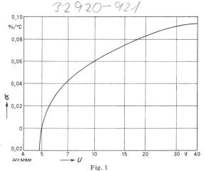
Abhängigkeit des Temperaturkoeffizienten von der Zenerspannung
