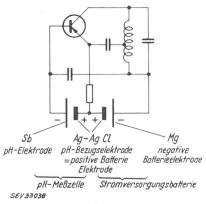
Fig. 2 Schaltung der «Heidelberger Kapsel»
