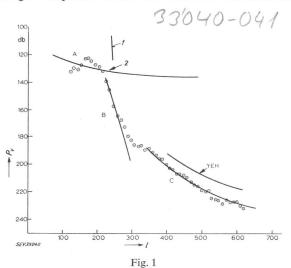
Übertragungsverluste im VHF-Bereich in Abhängigkeit von der Entfernung Frequenz 220 MHz, Antennenhöhe der Bodenstation 25 m, Flughöhe 9000 m
