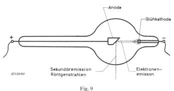
Prinzipschema einer Röntgenröhre
