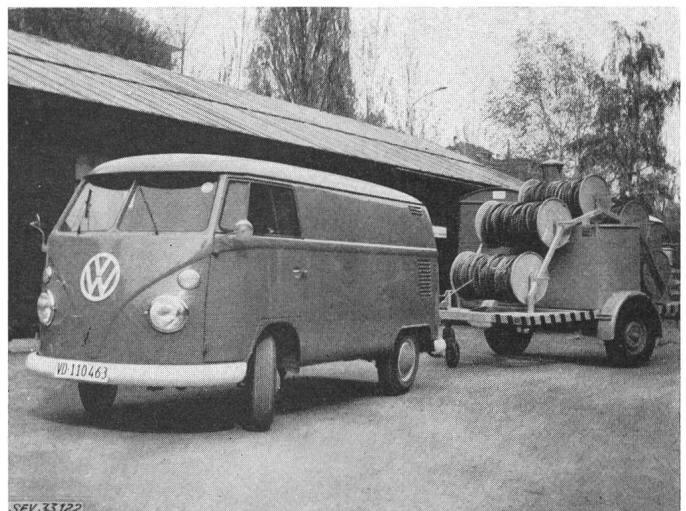
Fig. 18 Véhicule de l'équipe d'exploitation des réseaux de l'Exposition équipé d'un radio-téléphone et d'une remorque avec torche de câble volant pour liaisons de secours
