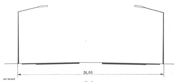
Fig. 2 Kandelaber an den Aussenseiten (Aussenanordnung)
