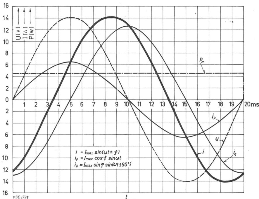
Es findet also auch bei  $\cos \varphi = 0$  eine Verschiebung elektrischer Energie statt, allerdings wird der in einer Viertelperiode abgegebene Betrag im nächsten Viertel wieder vollständig an das speisende Netz zurückgegeben. In der Impedanz verbleibt nichts.
