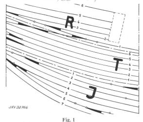
Gleisfeldausschnitt mit Abschnittbezeichnung und Numerierung der einzelnen Geleise
