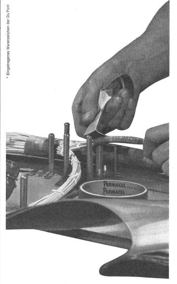
Ein Kabelbaum wird für die Verlegung in einem Flugzeug mit PERMACEL Teflon\*-Band P-421 gebündelt, und zwar an denjenigen Stellen, die dem grössten Abrieb und Druck und der grössten Hitze ausgesetzt sind. Denn PERMACEL P-421 hat ausgezeichnete elektrische Eigenschaften, höchste Beständigkeit gegen thermische, mechanische und chemische Einwirkungen und einen minimalen Reibungskoeffizienten. Das PERMACEL Teflon\*-Band ist ein Erzeugnis von
