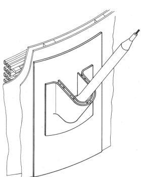
Transformerboard besteht aus einer grossen Zahl dünner Lagen eines erstklassigen Spezialpapiers, welche unter hohem Druck miteinander vereinigt werden
