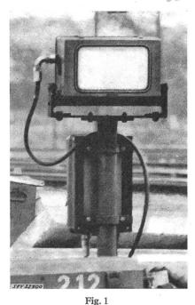
Radargerät zur Überwachung von der Geschwindigkeit der Waggons
