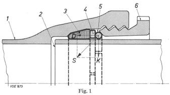
Elektrisch überbrückte Schraubmuffe (System Ryf)
