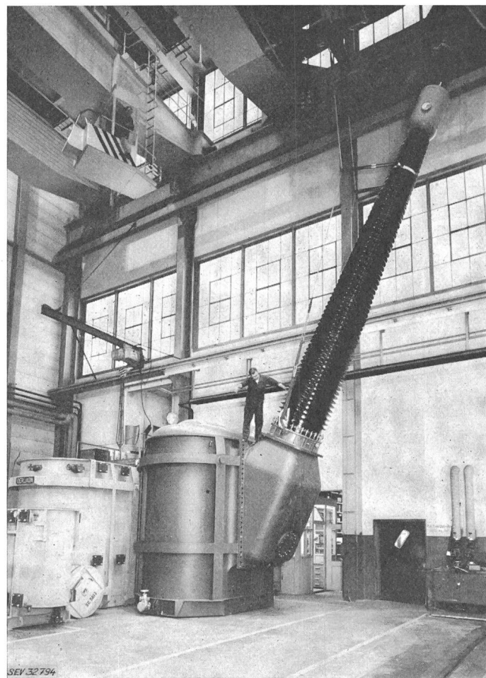
Fig. 12 Transformator-Prototyp für 750 kV beim Einsetzen der Hochspannungs-Durchführung (Maschinenfabrik Oerlikon)
