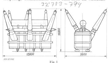
Massbild eines 500-MVA-Autotransformators für 750/420/22 kV, 50 Hz
