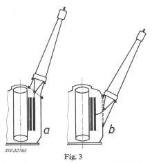
Anordnung des Hochspannungsanschlusses von 750-kV-Transformatoren a Anschluss am oberen Wicklungsende; b Anschluss in der Wicklungsmitte
