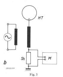
Schéma pour la mesure de l'ionisation interne d'un transformateur lors de l'essai par tension induite
