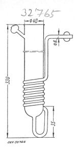
Fig. 1 Reaktionsgefäss für die Öl-Alterung
