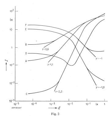
Kennlinien des EL-PC-Bildverstärkers E Eingangs-Beleuchtungsstärke; I Ausgangs-Lichtstärke
