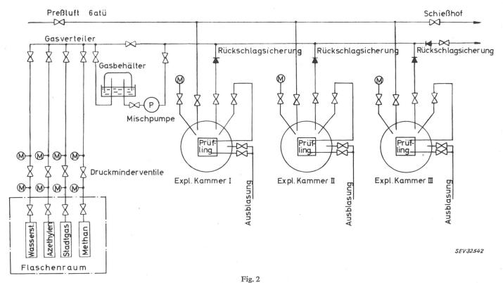
Gasschaltplan des Explosionsprüffeldes der Elin-Union, Werk Stadlau, mit drei druckfesten Explosionskammern
