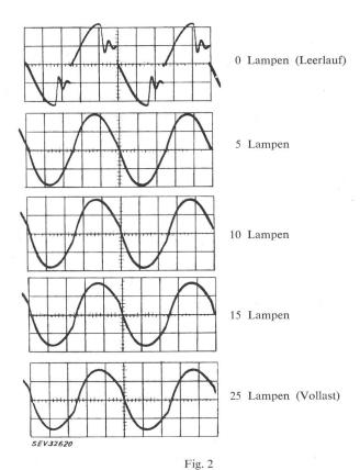
Verlauf der Wechselrichter-Ausgangsspannung  $\boldsymbol{u}_a$  bei Speisung von 40-W-Leuchtstofflampen
