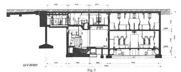
Querschnitte durch das Unterwerk
