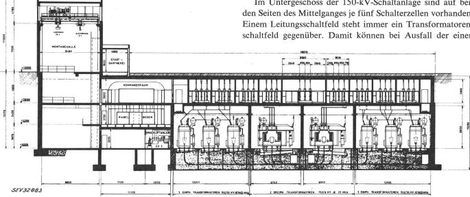
Fig. 7 Längsschnitt durch die Transformatorenzellen, den 50-kV-Schalterraum, den Kommandoraum, Kabelboden und die Montagehalle
