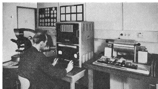
Fig. 1 Elastomat zur zerstörungsfreien Ermittlung bestimmter mechanischer Eigenschaften gegossener Probekörper
