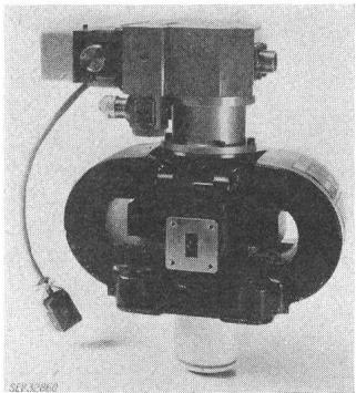
im Frequenzband von 12,4...18,0 GHz. Der Typ SYM-4328, ein Magnetron mit einer minimalen Ausgangsleistung von 90 kW, vereinigt den Vorteil der koaxialen Konstruktion mit dem einer hydraulischen Frequenzabstimmung.
