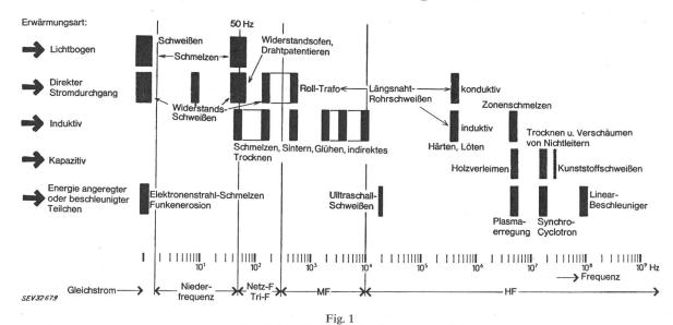
Anwendung der Elektrowärme nach Erwärmungsart und Frequenz
