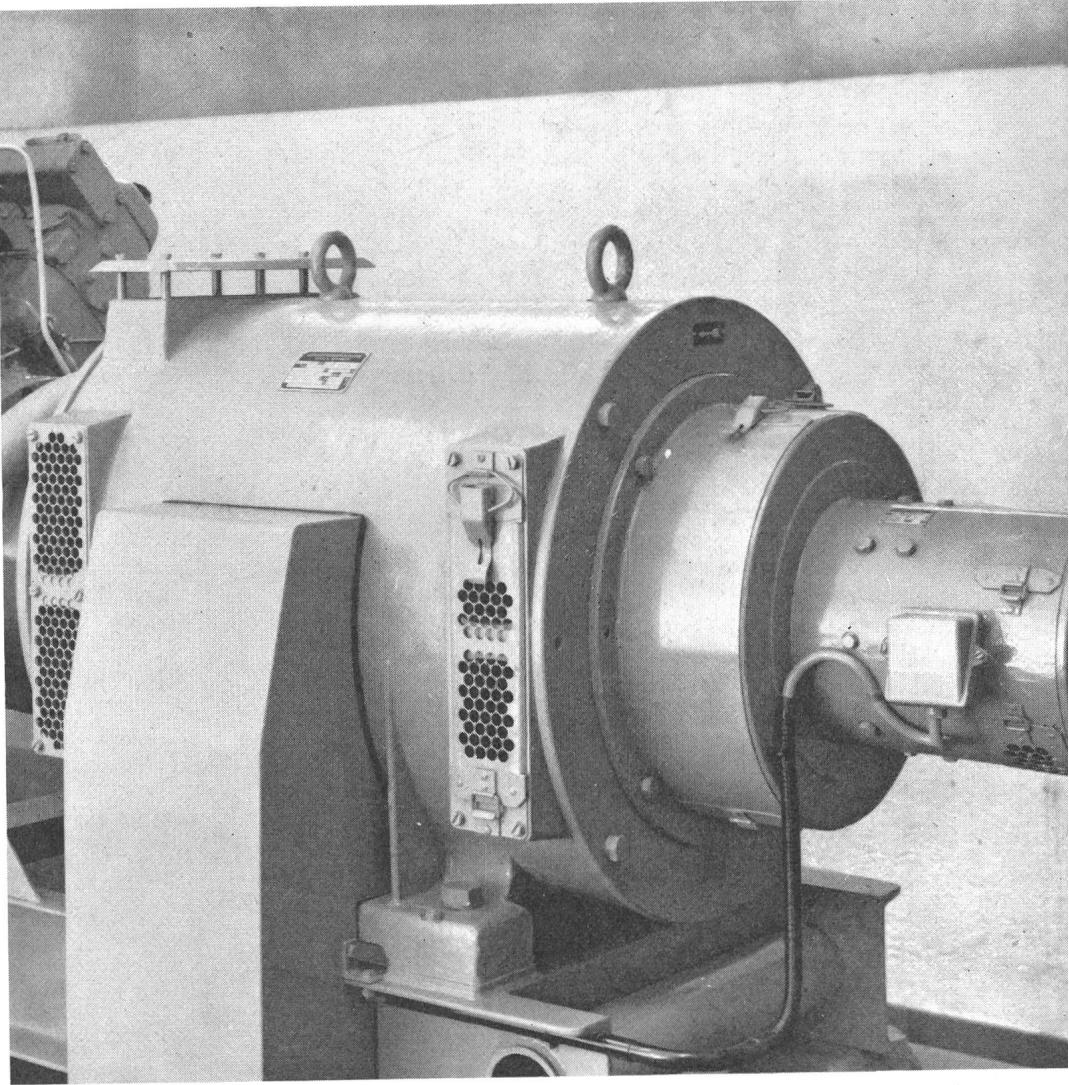
**Notstromanlagen 30 bis 500 kVA und mehr.
