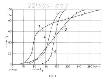
Integralkurven der Häufigkeitsverteilung elektrischer Durchschlagsfeldstärke  $E_d$  von 0,012 mm dicken Melinex-Folien und von 0,05 mm dicken Hostaphan-Folien
