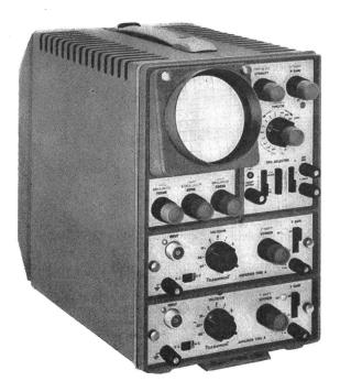
D-33 Zweistrahloszillograph mit zwei Einschubverstärkern, 3 div. Modelle 3½"-Röhre mit 3,5 kV Nachbeschleunigung 60 ns Anstiegszeit
