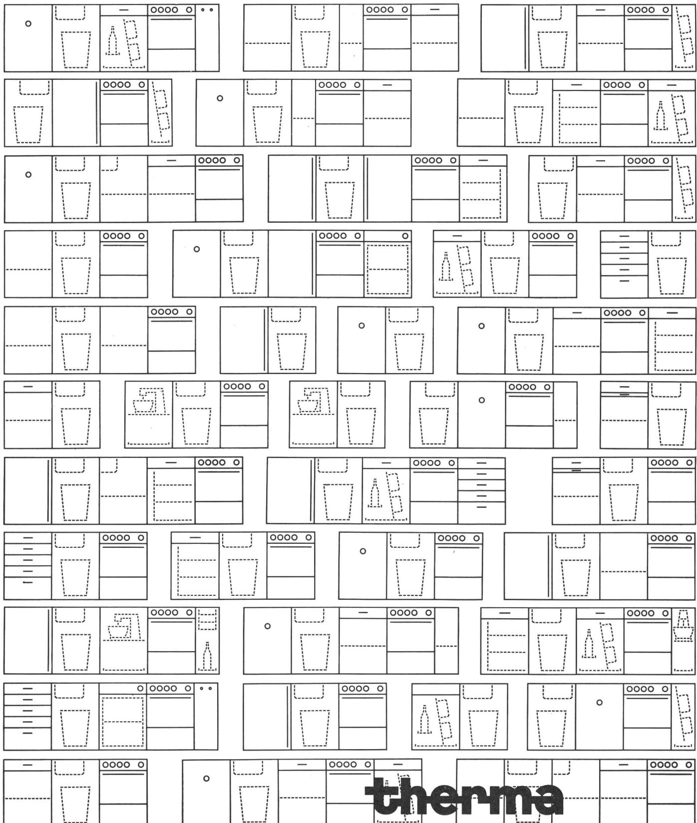
Therma-Kombinationen aus formlich übereinstimmenden, genormten Elementen aufgebaut – eine geschlossene Einheit bildend
