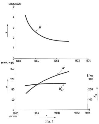
Entwicklung des Uranpreises, der Energieausbeute und der Brennstoff-Kosten pro erzeugte kWh in den nächsten Jahren
