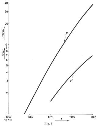
Voraussichtlicher Ausbau der Kernkraftwerke in den USA P maximal mögliche Leistung ab Generator p Anteil an der totalen installierten Leistung
