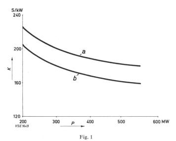
Spezifische Baukosten der Kernkraftwerke mit wassergekühlten Reaktoren, die 1967 den Betrieb aufnehmen können
