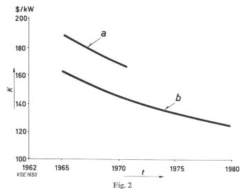
Voraussichtliche Entwicklung der spezifischen Baukosten von Kernkraftwerken mit einer elektrischen Leistung von ca. 500 MW in den nächsten Jahren
