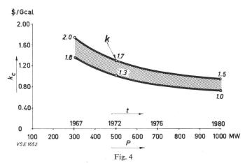
Aequivalente Kohlenkosten für Kernkraftwerke in Funktion der elektrischen Leistung und des Jahres der Inbetriebsetzung
