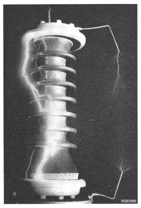
$Fig.~1 \\ \textbf{Stossüberschlag über einen Stützisolator} \\ Die~15~0/_0~enger~eingestellte~Funkenstrecke~überschlägt~nicht}$
