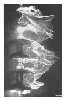
Fig. 2 Stromschwacher Lichtbogenüberschlag über eine Isolatorenkette Der leitende Plasmaschlauch wird durch einen Seitenwind weggeblasen
