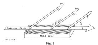
Prinzipschema der Breitband-Strahlungsquelle
