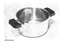
Die thermischen Eigenschaften der Kasserollen sind gut und der Boden hat bei der Formbeständigkeitsprüfung keine grosse Deformation erlitten. Solche Kasserollen sind daher für Verwendung auf elektrischen Herden geeignet.
