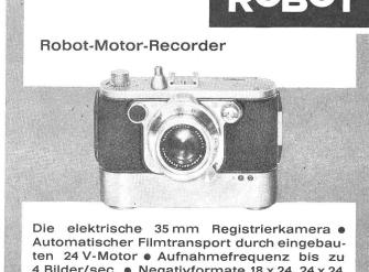
Die elektrische 35 mm Registrierkamera • Automatischer Filmtransport durch eingebauten 24 V-Motor • Aufnahmefrequenz bis zu 4 Bilder/sec. • Negativformate 18 x 24, 24 x 24, 24 x 36 mm • Ausbaumöglichkeit zur vollelektrischen Registrieranlage • Filmfassungsvermögen bis zu 60 m • Wechselobjektive bis zu f = 600 mm • Durch Einspiegelungssystem gleichzeitige Aufnahme von Haupt- und Nebenobjekten • Filmprojektionsfähigkeit bei Negativformat 18 x 24 mm •
