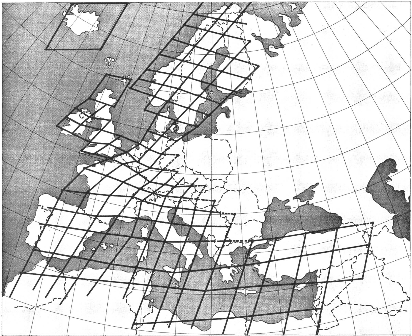
Fig. 3 Verteilung der Netzzellen über Westeuropa, gültig für die Bänder IV und V
