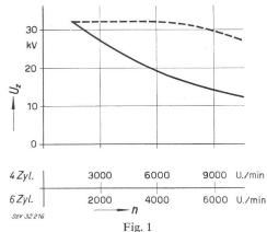
Zündspannung  $U_z$  in Funktion der Motordrehzahl n
