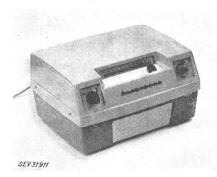
selben. Er besteht zur Hauptsache aus einem Ansagewerk, einem Tonaufnahme- und Wiedergabeapparat sowie den zugehörenden Verstärker- und Relaisteilen. Anschluss über Netztransformator mit getrennten Wicklungen. Schutz vor Überlastung durch Kleinsicherungen im Netz- und in den Sekundärstromkreisen. Antrieb der Sprechwerke durch Spaltpolmotor. Elektronischer Teil transistorisiert. Einzelteile auf Metallchassis in Gehäuse aus Isoliermaterial. Zuleitung Doppelschlauchschnur mit Stecker 2 P + E.
