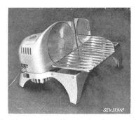
Gehäuse aus lackiertem Metall mit eingebautem Schalter. Zuleitung Doppelschlauchschnur mit Stecker 2 P + E.
