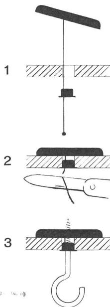
Ein neues TUFLEX-Befestigungselement, besonders geeignet für Leichtbauweisen, wie z. B. für Hohldecken, abgehängte Decken, Weichstoffplatten usw. Balkenlänge 54 mm und 32 mm. Für Holzschrauben und Deckenhaken.
