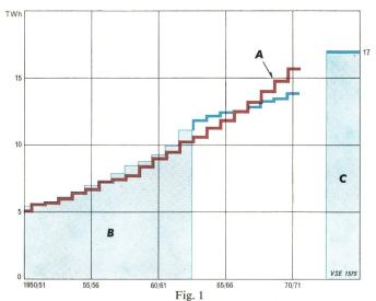
Deckung des Verbrauches durch die Wasserkrafterzeugung im Winterhalbjahr
