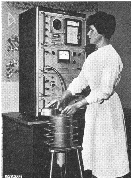
Fig. 11 Impulshöhen-Analysator mit Strahlungsdetektor in Bleikammer zur spektrometrischen Auswertung radioaktiver Präparate
