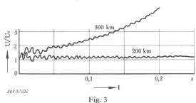
Berechnung des Selbsterregungsvorganges von Synchronmaschinen Eine 100-MVA-Maschine speist über eine 380-kV-Leitung in ein Netz ein. Beim Abschalten der Leitung am netzseitigen Leitungsende entwickelt sich die Klemmenspannung entsprechend den angegebenen Kurven. Die Kurven sind die Umhüllenden der 50-Hz-Spannung Bei 300 km Leitungslänge tritt schnelle, bei 200 km Leitungslänge
