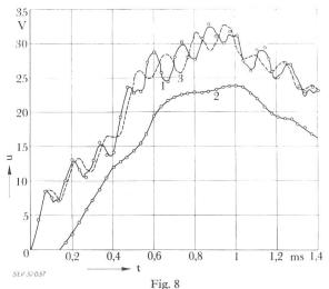
Wiederkehrende Spannung beim Abschalten im Punkte  $P_1$  des Netzes in Fig. 7
