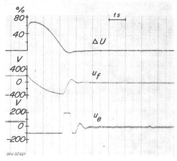
Fig. 2 Vorgänge beim Abschalten einer langen Freileitung am entfernten Ende  $\Delta U$  Spannungserhöhung am kraftwerkseitigen Leitungsende nach der Abschaltung;  $u_t$  Spannung an der Feldwicklung des Generators;  $u_e$  die vom Spannungsregler gelieferte Spannung an der Feldwicklung der Erregermaschine
