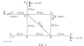
Schema eines Netzes zur Prüfung der Berechnungsmethoden für transiente Vorgänge auf Leitungen
