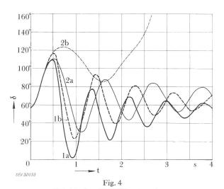
**Beispiel einer Stabilitätsuntersuchung** Übertragung von 800 MW über eine 300 km lange 380-kV-Doppel-
