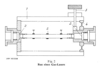
I Invarstäbe; 2 reflektierende Spiegelschichten; 3 Einstellschraube für planparallele Spiegel; 4 verformbare Membran; 5 HF-Sender
