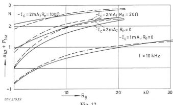
$a_{k2}$  als Funktion des Generatorinnenwiderstandes  $R_n$  bei tiefer Frequenz für  $R_2 \longrightarrow 0$ ,  $R_c = 0$ ;  $\mu = 1$
