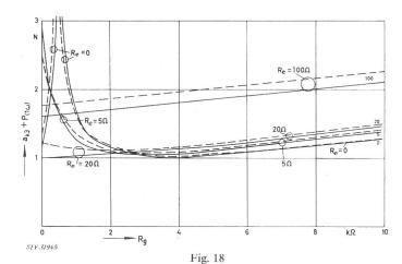
Klirrdämpfung  $a_{k3}$  der 3. Harmonischen als Funktion des Generatorinnenwiderstandes  $R_g$  bei verschieden grossen Emittervorwiderständen  $R_c$  für tiefe Frequenzen
