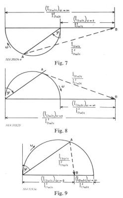
Fig. 7, 8 und 9 Vektordiagramme zur Ermittlung der 2. Harmonischen bei endlichen Frequenzen
