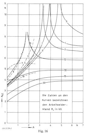
$a_{k2}$ als Funktion der zusätzlichen Gegenkopplung A [N] bei verschiedenen grossen Arbeitswiderständen  $R_{\,c}$
