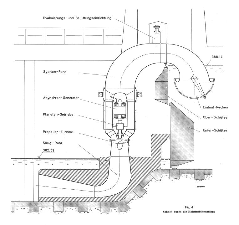
Das obere Führungslager ist an die Schmierung des Getriebes angeschlossen.
