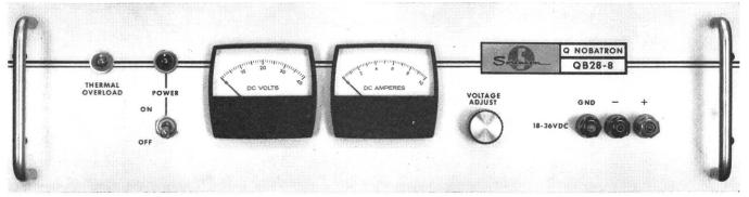
Das universelle QB Nobatron ist ein neues Gerät des grossen SORENSEN-Reglerprogramms. Wie bei den neuesten QR-Typen ist auch beim QB Nobatron die Strom-Stabilisierung möglich. Die Geräte sind für Eingang 105–125 und 210–250 V $\sim$  konstruiert. Sie arbeiten einwandfrei mit einer Eingangsfrequenz von 50–400 Hz. Die Ausgangsimpedanz beträgt durchschnittlich 0,001 $\Omega$  + 0,3  $\mu$ H.
