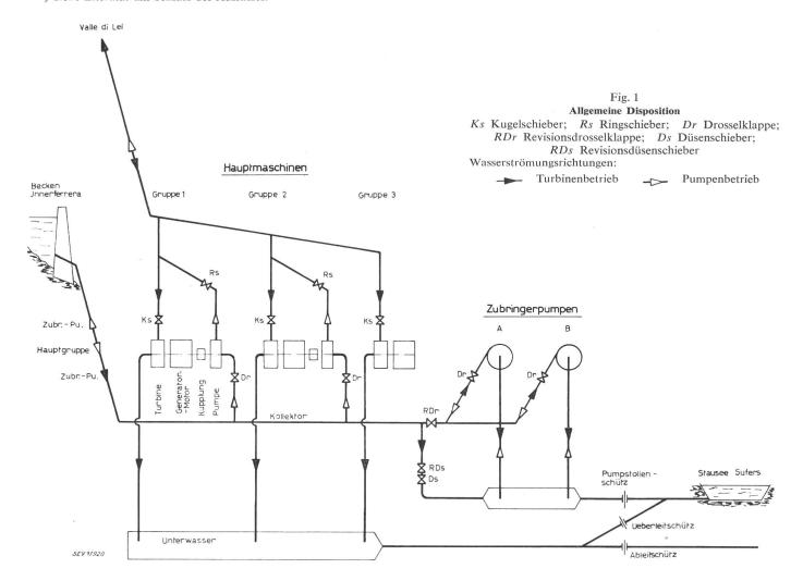
Mit zwei Hauptmaschinengruppen kann also wahlweise das aus dem Stausee Valle di Lei zur Verfügung stehende Wasser verarbeitet und damit Energie in das Hochspannungsnetz abgegeben oder Wasser aus dem Ausgleichsbecken Innerferrera in den Stausee Valle di Lei hinaufgepumpt werden.
