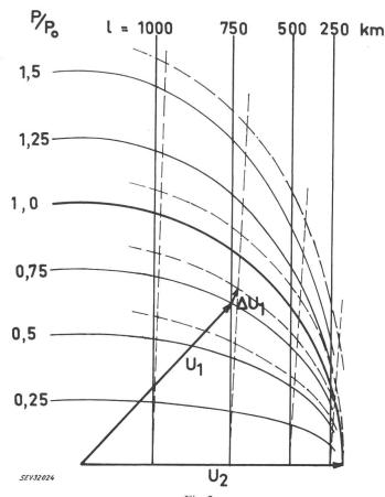
Fig. 2 Notwendige Eingangsspannung bei konstanter Ausgangsspannung für: (ausgezogen)  $\alpha = 0$ ,  $\beta = 1,3 \cdot 10^{-3}$  rad/km;
