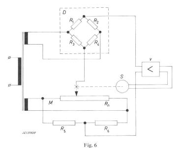
Prinzipschaltbild der elektronischen Waage
