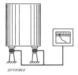
Fig. 13 Elektronische Behälterwaage für Inhaltswiegung und Inhaltsüberwachung
