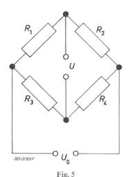
Brückenschaltung zur Kompensation des Temperatureinflusses  $R_1$ ,  $R_4$  aktiver Streifen;  $R_2$ ,  $R_3$  Kompensationsstreifen; U Meßspannung;  $U_0$  Speisespannung
