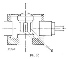
Schnitt durch eine Druckdose bestückt mit Dehnungsmeßstreifen D
