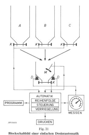
A, B, C Mischkomponenten; K Klappe oder Ventil; M Mischer;
