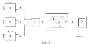
Blockschema einer elektronischen Waage A Druckaufnehmer; B Messbrücke nach dem Kompensationsverfah-
