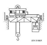
Fig. 17 Elektronische Kranwaage
