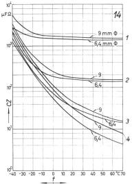
Fig. 13 CZ-Produkte zweier Miniatur-Elektrolyt-Kondensatoren von 32  $\mu F$ , 6,4 V (Abmessungen 6,4 mm  $\phi \times$  18 mm) und 160  $\mu F$ , 6,4 V (Abmessungen 9 mm  $\phi \times$  30 mm) in Funktion der Temperatur t
