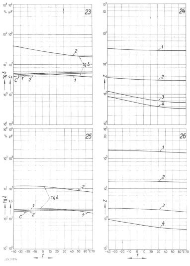
Fig. 27 und 28 Kapazität: 25  $\mu$ F Betriebsspannung: 6,4 V Abmessungen: 6,4 mm  $\phi \times$  20,5 mm
