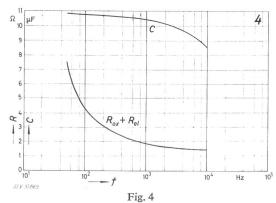
Kapazität C und äquivalenter Serienwiderstand R eines Elektrolyt-Kondensators von 10  $\mu F$ , 25 V, in Abhängigkeit von der Frequenz f bei 20  $^{\circ}C$
