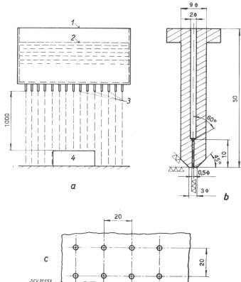
${f Tropfwasserapparat}$ a Prüfanordnung; b Tropfkapillare; c Anordnung der Tropfkapillaren im Boden des Wassergefässes; 1 Gefäss; 2 Wasserfüllung: 3 Tropfkapillaren: 4 Prüfling
