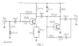
Schaltung eines zweistufigen Breitband-Verstärkers für 75 Ω Anpassung
