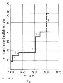
Zunahme der spezifischen Leistung bei Personenwagen-Lichtmaschinen (Stadtfahrleistung pro Kilogramm Gesamtgewicht)
