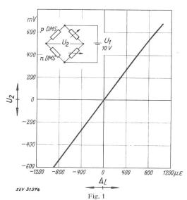
Ausgangsspannung  $U_2$  in Abhängigkeit von der Dehnung  $\Delta l$  des Halbleiterdehnungsstreifens (DMS)
