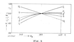
Netzspannungsabhängigkeit einer Na 220 W
