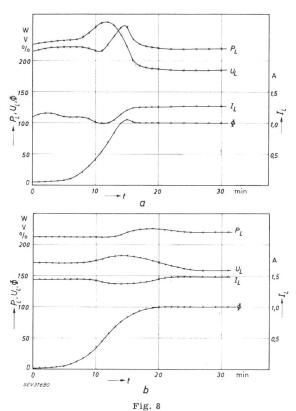
Anlaufverhalten von Natriumdampflampen in Stabform Lampenleistung  $P_L$ , Lampenspannung  $U_L$ , Lampenstrom  $I_L$  und Lichtstrom  $\Phi$  in Abhängigkeit von der Zeit t nach dem Einschalten der Lampe
