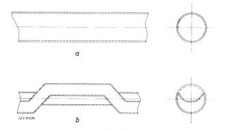
Glattes (a) und verformtes (b) Entladungsrohr
