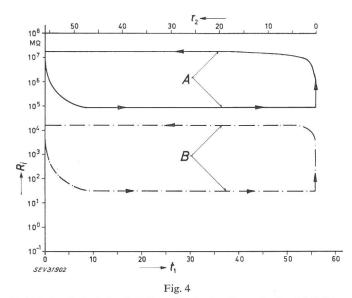
Idealisierter Verlauf des Isolationswiderstandes  $R_i$  zweier handelsüblicher Installationsmaterialien aus keramischem Isolierstoff wärend der Lagerung in ca. 93 % relativer Feuchtigkeit bei ca. 23 °C ( $t_1$  in Anzahl Tage) sowie während der hieran anschliessenden Lagerung in trockener Luft von ca. 45 % relativer Feuchtigkeit bei 23 °C ( $t_2$  in Anzahl Tage)
