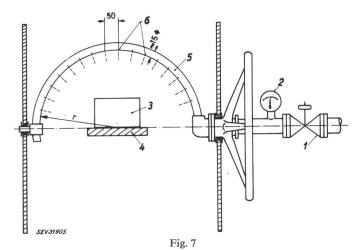
Schwenkrohr zur Prüfung der Spritzwassersicherheit nach DIN 40060, Blatt 2
