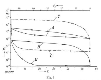
Idealisierter Verlauf des Isolationswiderstandes  $R_i$  handelsüblicher Installationsmaterialien aus organischen Isolierstoffen während der Lagerung in ca. 93 % relativer Feuchtigkeit bei ca. 23 °C ( $t_1$  in Anzahl Tage) sowie während der hieran anschliessenden Lagerung in trockener Luft von ca. 45 % relativer Feuchtigkeit bei 23 °C ( $t_2$  in Anzahl Tage)
