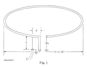
Ringstrahler mit Einspeisung und variabler Endkapazität für Mehrband-Betrieb
