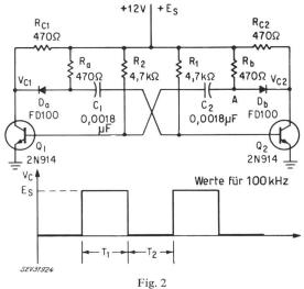
Stromkreis für verbesserte Rechteckform der Kollektor-Ausgangsspannung mit zugehöriger Kurvenform
